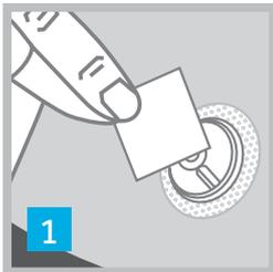
1 Das Septum vor jeder Anwendung mit destilliertem Wasser reinigen.
